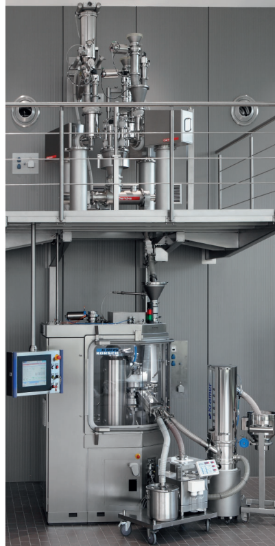
Abbildung 2: Produktionsanlage zur kontinuierlichen Direktverpressung einer Rezeptur bestehend aus bis zu 3 Rohstoffen. (Quelle: L.B. Bohle).
